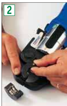
2 Wciśnięcie wkładek zaciskowych z blokadą bezpieczeństwa.
